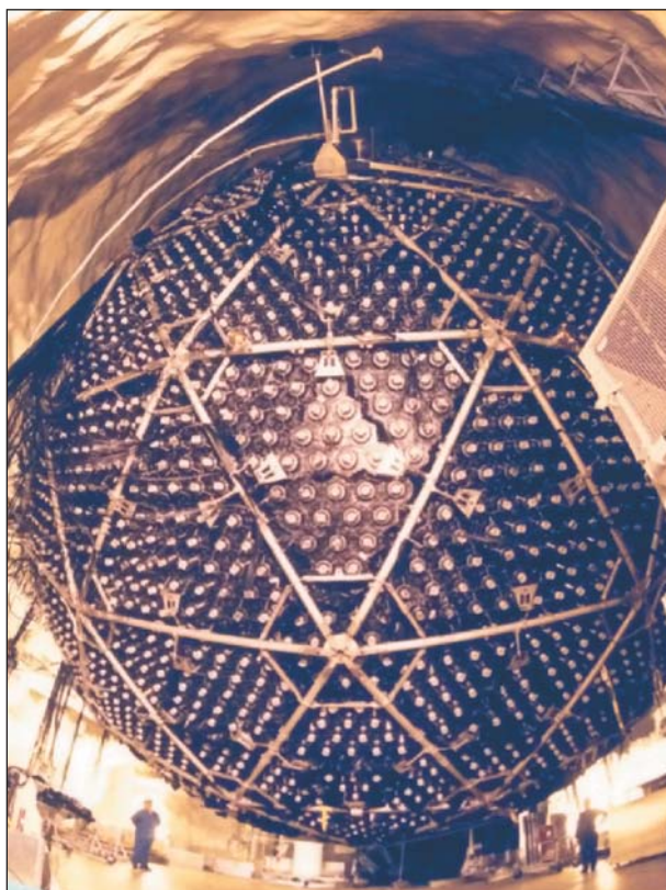
Рис.1. Объемное изображение детектора SNO, расположенного в подземной лаборатории Садбери (Канада).
